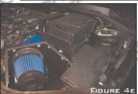
E) TIGHTEN THE COBB PROVIDED HOSE CLAMP BETWEEN THE MAF HOUSING AND SILICONE ELBOW. WHEN COMPLETE, THE ASSEMBLY SHOULD APPEAR AS SHOWN IN FIGURE 4E.
